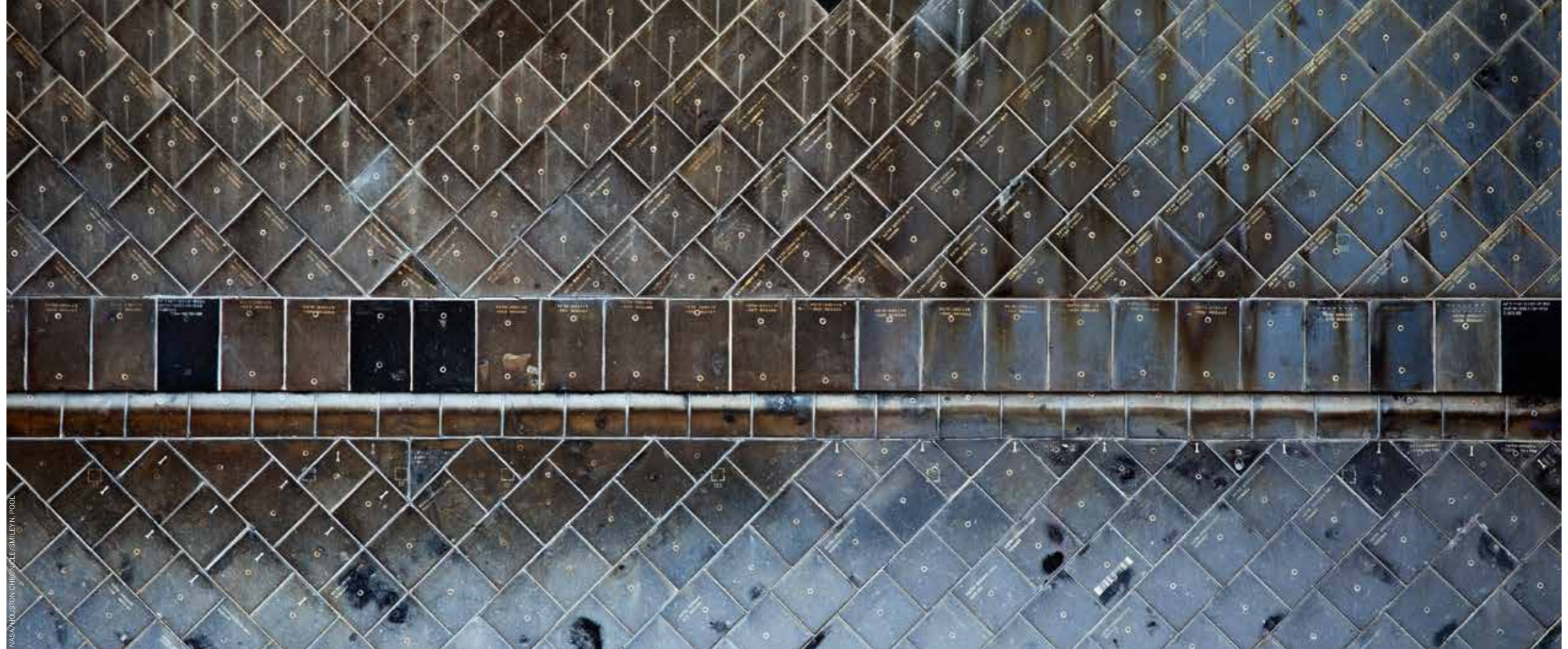
De spaceshuttles waren aan de onderkant voorzien van 24.000 keramische tegels. Tijdens terugkeer in de dampkring wordt de buitenkant meer dan 1.600 °C. Beschadiging van slechts één tegel heeft desastreuze gevolgen, zoals de ramp met de Columbia bewees.
