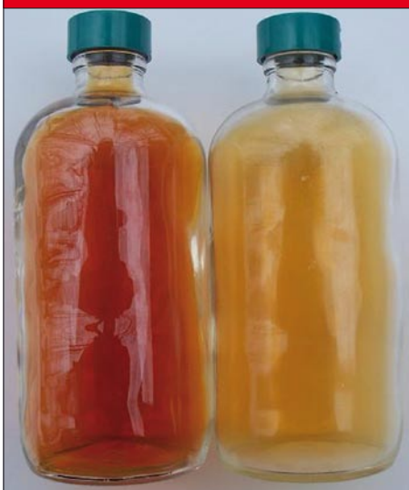
Flessen gevuld met stikstofdioxide ( \text{NO}_2 , links) en distikstoftetraoxide ( \text{N}_2\text{O}_4 , rechts). De lichtbruine kleur in de rechtse fles is afkomstig van een kleine hoeveelheid stikstofdioxide, hetgeen de dynamische evenwichtstoestand van de dimerisatie illustreert.
