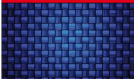
Glasvezels worden in de vorm van weefsels en matten gebruikt ter versterking van kunststoffen.
