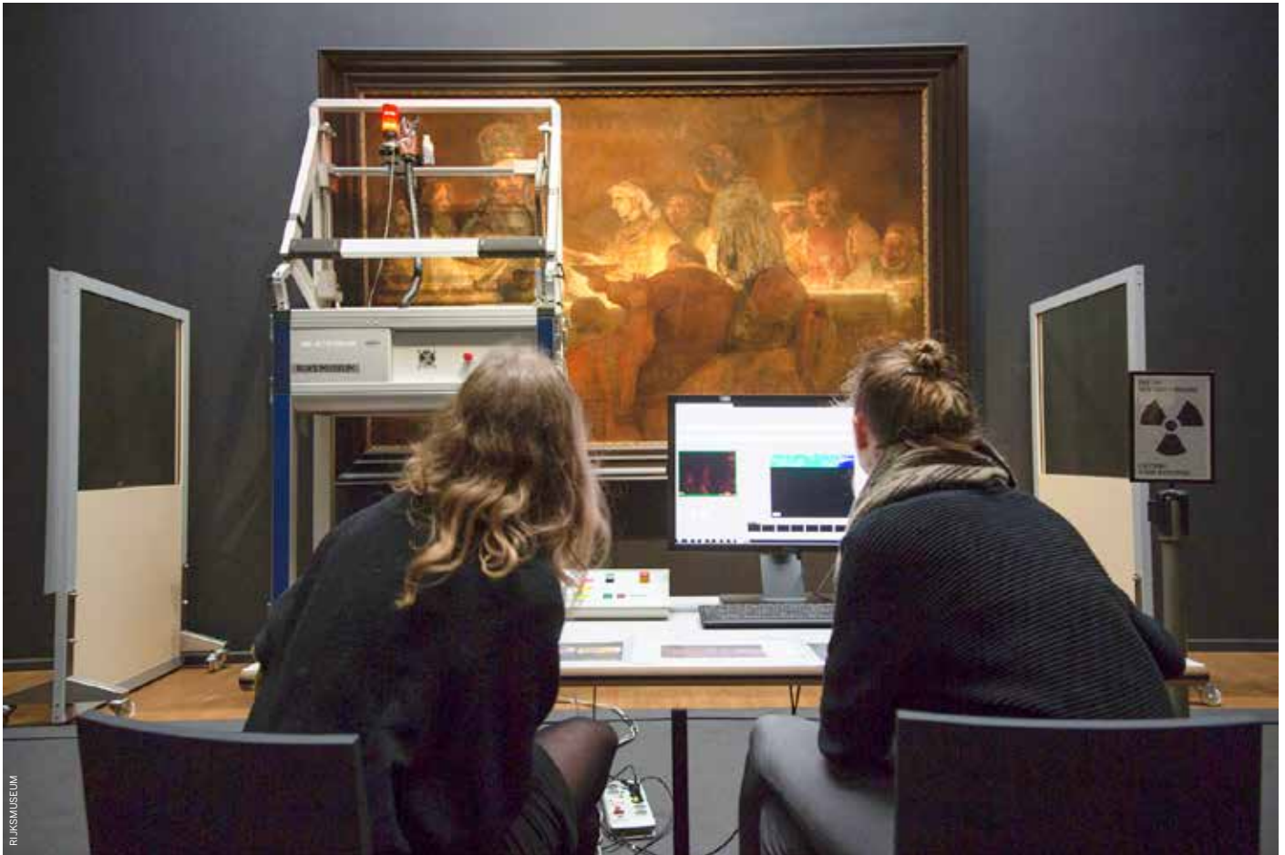
Een macro-röntgenfluorescentiescanner (MA-XRF) voor het schilderij De samenzwering van de Bataven onder Claudius Civilis (circa 1661-62) van Rembrandt van Rijn. Met behulp van deze scanner kunnen onderzoekers een verspreidingskaart maken voor alle afzonderlijke elementen die in het schilderij aanwezig zijn.
