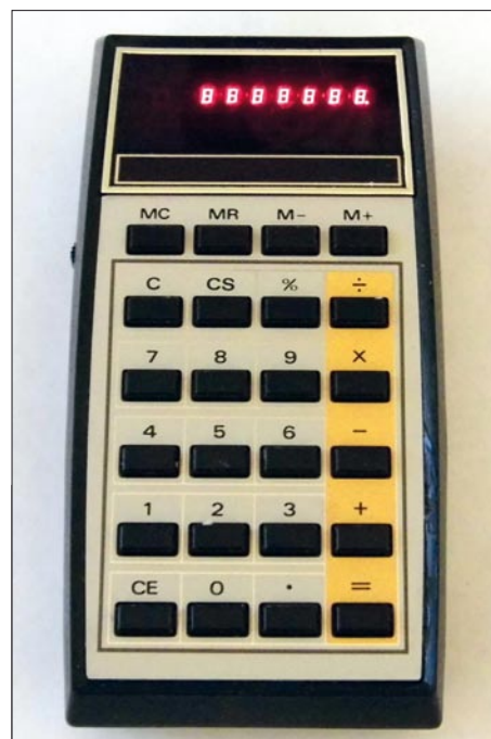
Rekenmachine met 7-LED cijferdisplay uit 1975.
