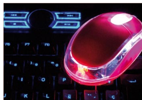
Computermuizen gecoat met PTFE glijden soepel en gemakkelijk over de muismat. Dit is te danken aan de lage wrijvingscoëfficiënt van teflon.
