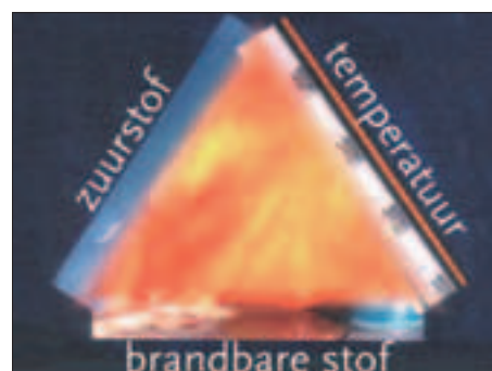
Een vuur dooft als niet wordt voldaan aan één van deze drie basisvoorwaarden.
