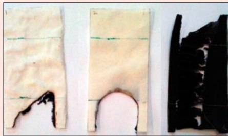
Met caseïne gecoate lapjes katoen, polyester en katoen-polyester (v.l.n.r.) die zijn blootgesteld aan een vlam.
